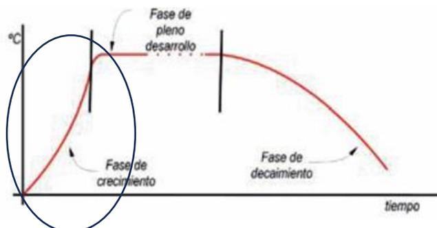
Los gases de incendio comienzan a acumularse en los estratos superiores. Al aumentar la temperatura, la densidad de los gases disminuye y aparece un efecto de flotabilidad que ayuda a extenderlos por todo el recinto
