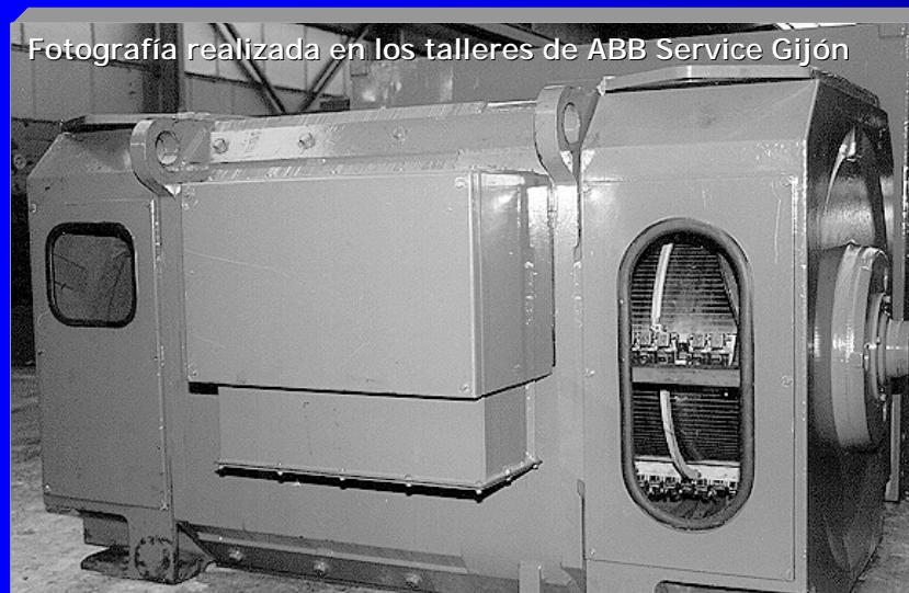
Motor de CC de 6000 kW fabricado por ABB
