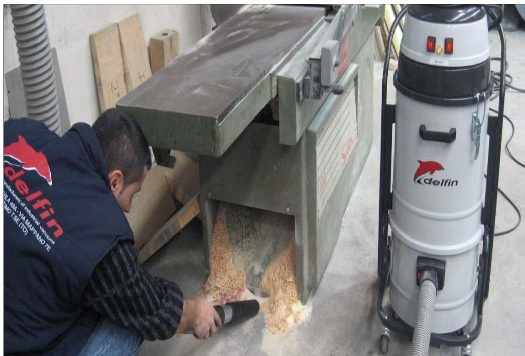
Figura 17. Limpieza de área en mantenimiento preventivo. Fuente: Recuperado de https://www.delfinvacuums.com/es/soluciones-de-aspiracion/aspiradores-industriales-para-serrin-y-polvo-de-madera
