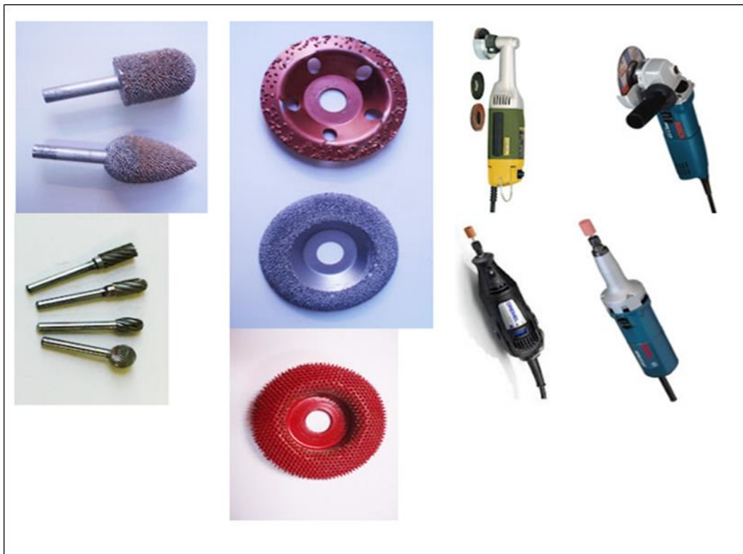
Figura 47. Amoladoras y mini amoladoras angulares y rectas. Fuente: Recuperado de https://www.homecenter.com.co/homecenter-co/guias-de-compra/Como-usar-la-sierra-circular/
