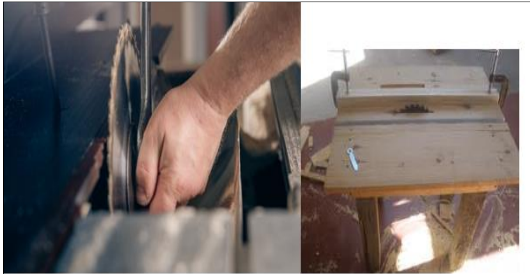
Figura 21. Cambio de disco de sierra. Fuente: Autoría propia.
