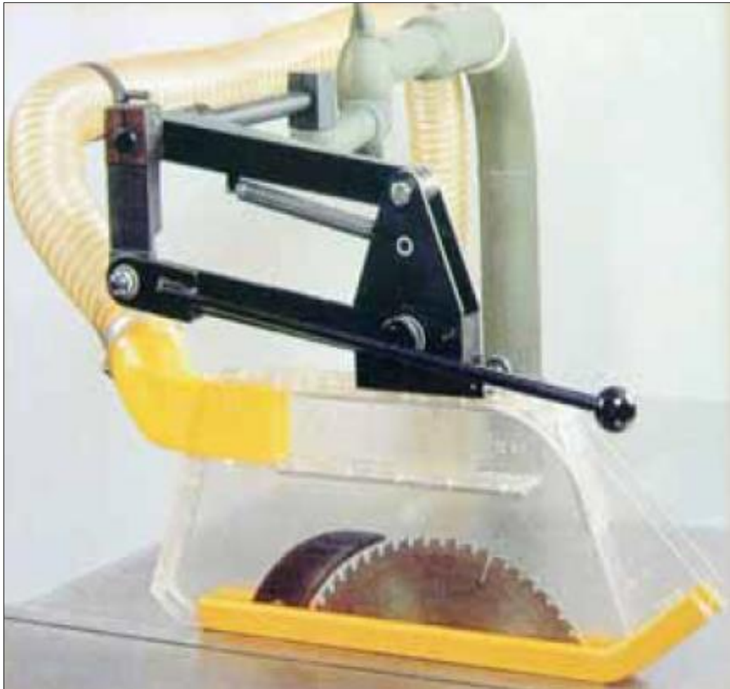
Figura 8. Carcasa superior-cubresiembras. Fuente: Recuperado de https://www.euskadi.eus/contenidos/libros/seguridad_200705/es_200705/adjuntos/seguridad_200705.pdf .
