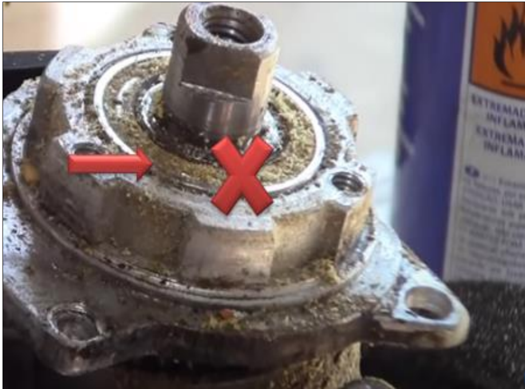
Figura 25. Pieza con viruta requerimiento de limpieza para lubricación. Fuente; Recuperado de https://youtu.be/hVbwIyH1pcQ
