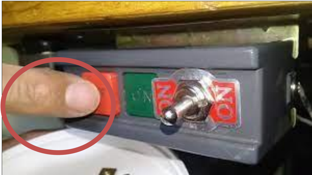
Figura 18. Apagado de máquina para el mantenimiento preventivo. Fuente: Recuperado de https://es.123rf.com/photo_34431828_botones-de-encendido-y-apagado-de-las-m%C3%A1quinas-de-sierra-circular-son-viejos-.html
