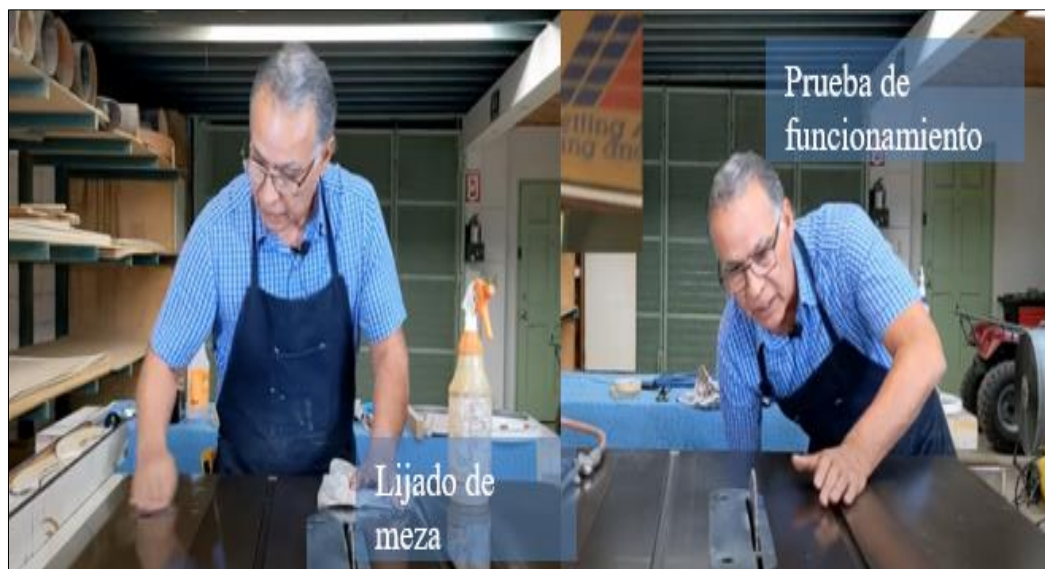
Figura 22. Lijado y prueba luego del mantenimiento. Fuente; Recuperado de https://youtu.be/hVbwIyH1pcQ
