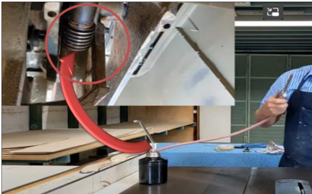
Figura 26. Piezas a lubricar en máquina de sierra circular. Fuente; Recuperado de https://youtu.be/hVbwIyH1pcQ
