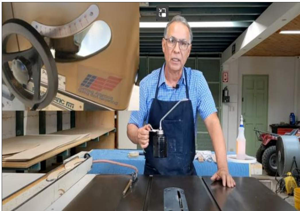
Figura 24. Proceso de lubricación de sierra circular. Fuente; Recuperado de https://youtu.be/hVbwIyH1pcQ
