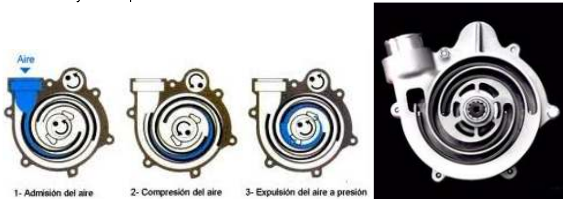
Imagen n°19: compresor tipo G
