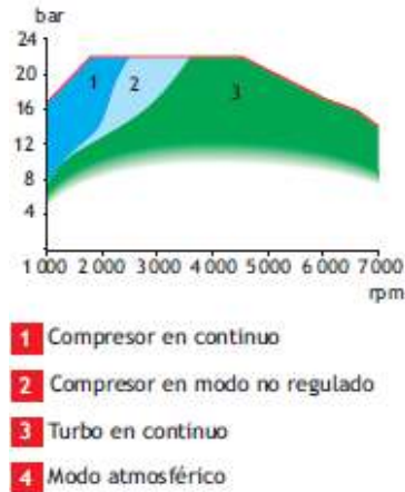
Imagen n°12: fases de trabajo en función del régimen del motor y la presión media efectiva
