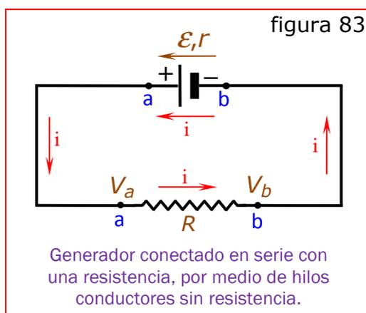
Consideremos un circuito sencillo como el de la *figura 83*, donde una *resistencia*  $R$  está conectada, mediante conductores de *resistencia despreciable*, a los terminales de un *generador* constituido por una *batería*.
