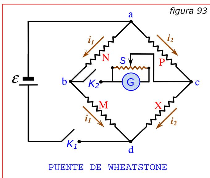
El puente de Wheatstone se emplea principalmente para efectuar medidas rápidas y precisas de resistencias. En la figura 93, M, N y P son resistencias variables previamente graduadas y X representa la resistencia desconocida. Para utilizar el puente se cierran los interruptores K1 y K2 y se modifica la resistencia P hasta que el galvanómetro G no experimente desviación. Los puntos b y c están ahora al mismo potencial, es decir, la caída de
