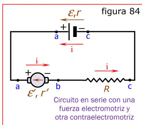
Consideremos ahora un circuito dentro del cual se realiza trabajo por la carga circulante. La *figura 84* representa un circuito en el cual hay un *motor* que es *accionado* por una *batería*. Para generalizar se ha introducido una *resistencia*  $R$ .
