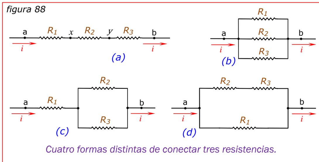
La *figura 88* presenta cuatro formas distintas de conectar *tres resistencias*  $R_1$ ,  $R_2$  y  $R_3$ . En la *figura 88a*, las *resistencias* ofrecen un *recorrido único* entre *a* y *b*, por lo que se dice que están conectadas en serie entre esos puntos. Todos los elementos componentes de un circuito (*resistencias*, *motores*, *generadores*, *etc.*) que análogamente ofrezcan un recorrido único entre dos puntos, se dice que están en serie entre esos puntos.
